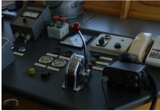
Εικόνα 4: άποψη του μοχλού ελέγχου φοράς κίνησης όπου σημειώνονται και οι ενδεικτικοί λαμπτήρες θέσης (εντός κόκκινου κύκλου)
